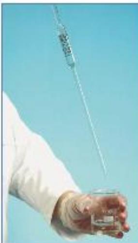
**3.** Verser l'acide contenu dans la pipette dans un autre bécher contenant de l'eau distillée.
