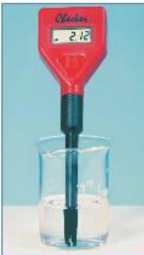
**1.** Verser un peu d'acide chlorhydrique dans un bécher et mesurer le pH de la solution.
